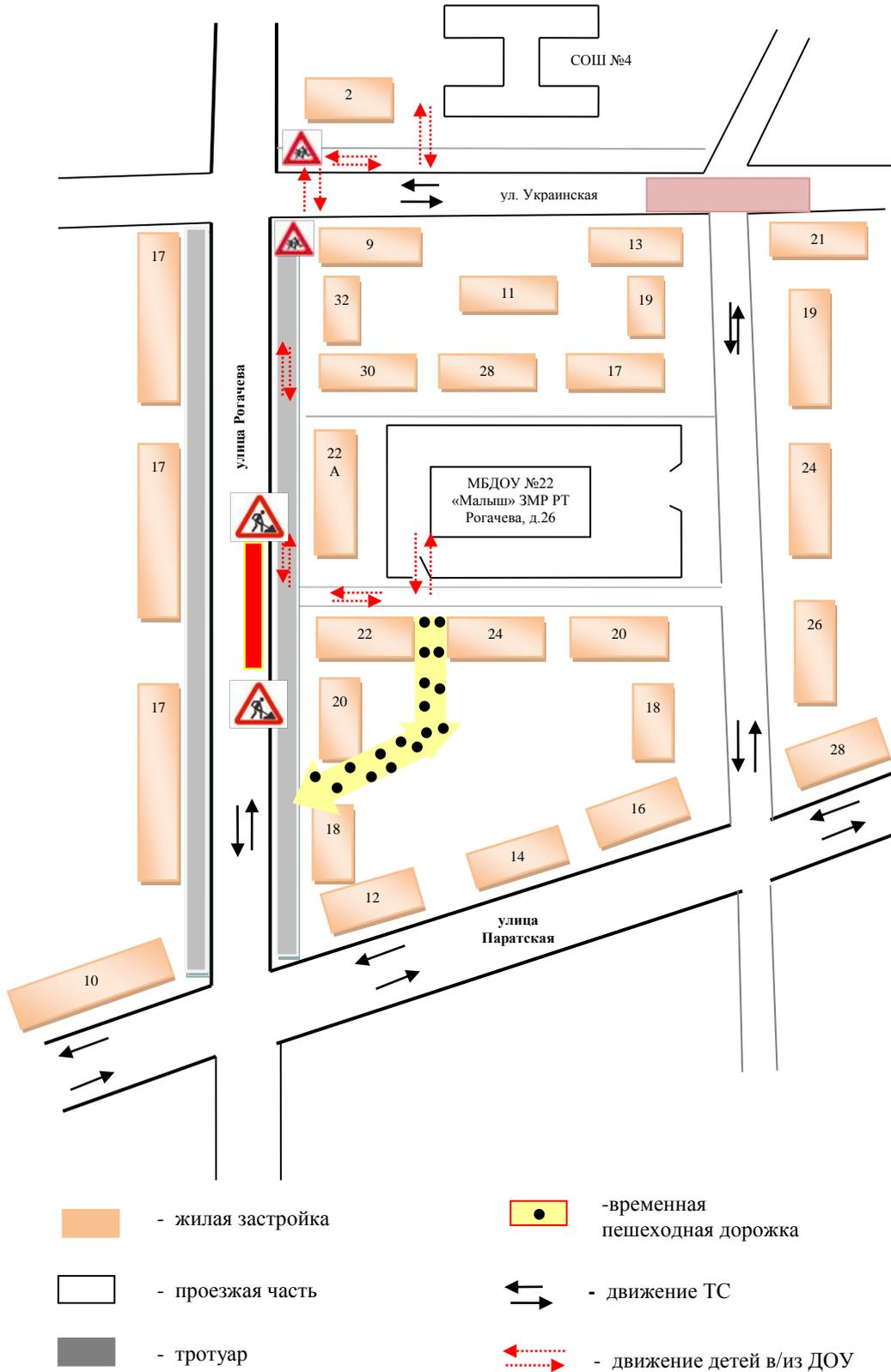
**Аннотация к плану-схеме пути движения транспортных средств и детей при проведении дорожных ремонтно-строительных работ вблизи образовательного учреждения**
